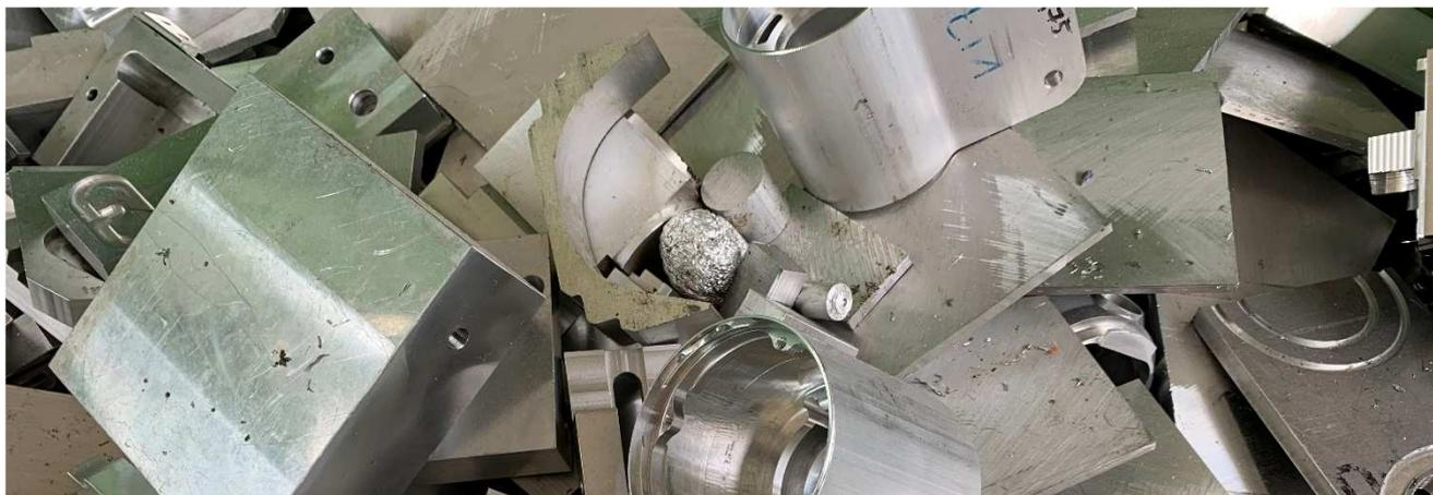
Die Sorte Alu-Abfälle gemischt beinhaltet sowohl Abfälle aus der Produktion wie Bleche, Rohre oder Profile und auch Abfälle aus dem Bau-Bereich wie Fensterbänke oder Fensterprofile.
