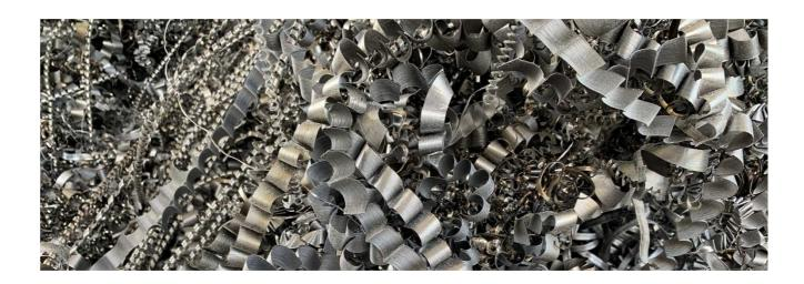
Die Sorte Stahlspäne (E5) ist stärker gekräuselt als Stahlwolle. Stahlspäne müssen frei sein von: NE-Metall, Zunder, Schleifstaub, stark oxidierten Späne, Kunststoffspäne oder Stoffen der chemischen Industrie sowie von Mineralikstaub.
