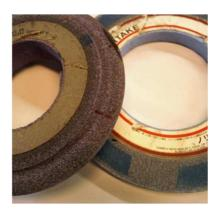
Schleifscheibenbruch, Korund, keramisch gebunden, mit geringfügigen Verunreinigungen und Anhaftungen
